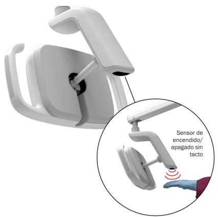
Mueva la mano a 76 mm (3 pulg.) por debajo del sensor de encendido/ apagado para encender o apagar la lámpara. Si la lámpara no se enciende, verifique que esté encendido el sistema dispensador o la alimentación del sillón.
