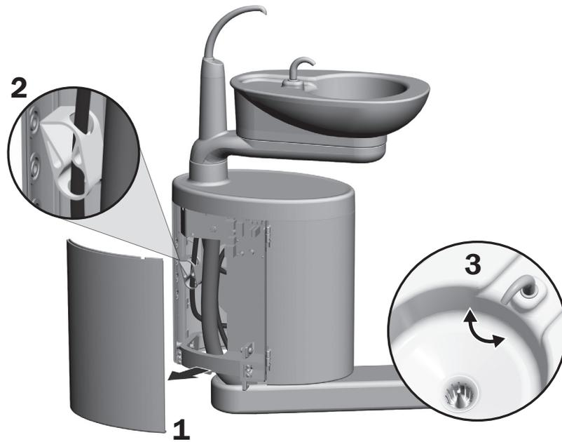
La función del tazón de enjuague debe proporcionar suficiente agua para enjuagar por completo el tazón de la escupidera. Si el flujo no es suficiente, se puede realizar un ajuste en el centro de soporte:
