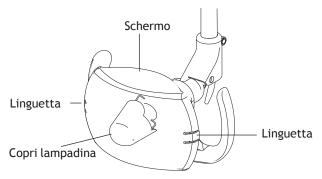
3. Rimuovere il copri lampadina ruotando in senso antiorario. Mettere da parte il copri lampadina.
