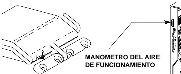
Figura 2. Manómetro del aire de funcionamiento
