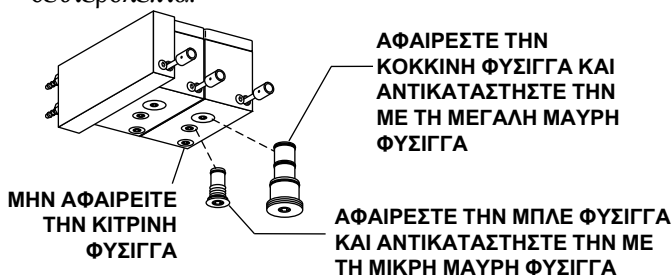
Εικόνα 13. Μετατροπή Ξηρού Κιβωτίου Χειρολαβής
