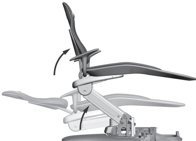
5. Appuyer sur un côté du cache supérieur du bras de levage afin de sortir les languettes latérales de leur logement à l'arrière du fauteuil et retirer le cache supérieur du bras de levage. Pendant le retrait de la partie supérieure, tenir le cache du bras de levage.
