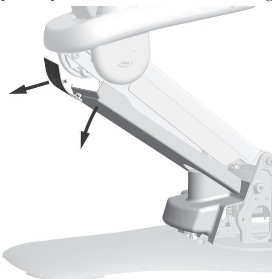
6. Soulever le cache du bras de levage et le retirer du fauteuil ainsi que le cache inférieur.
