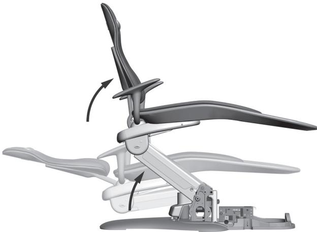
5. Presione un lado de la tapa del brazo de elevación superior para quitar las lengüetas del borde de la ranura en la parte posterior del sillón y quite la tapa del brazo de elevación superior. Tome la tapa del brazo de elevación mientras saca la tapa del brazo de elevación superior.
