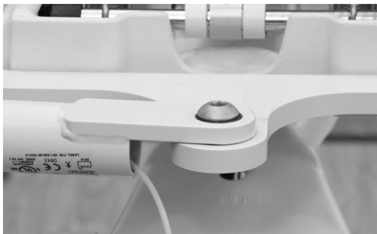
Rameno nástrojů asistenta s nainstalovanými držáky spínačů aktivovaných vzduchem.
