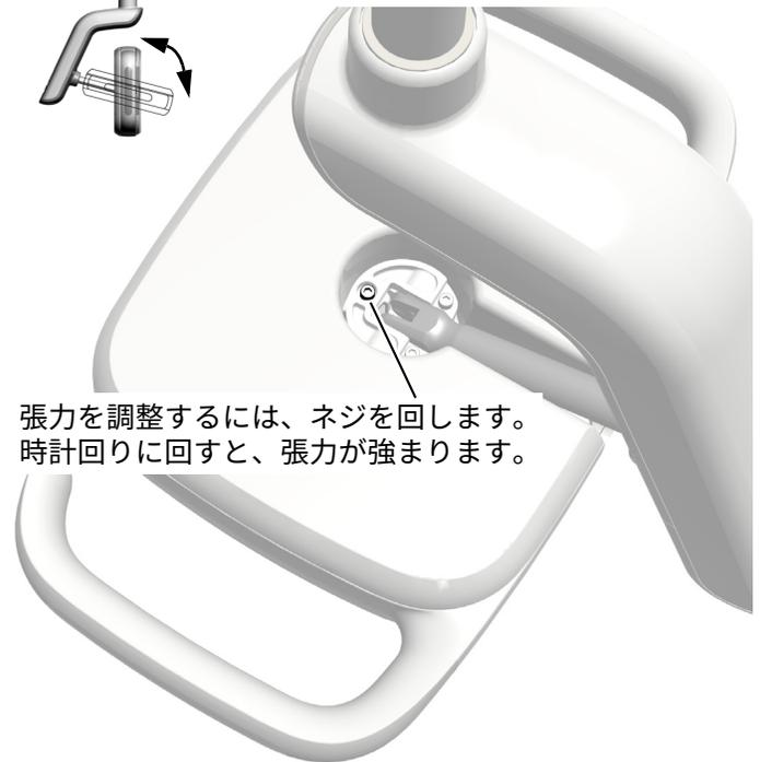
張力を調整するには、ネジを回します。時計回りに回すと、張力が強まります。
