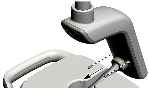
2. ドライバーハウジングをしっかりと握り、親指でドライバーハウジングカバーを押し出して外します。
