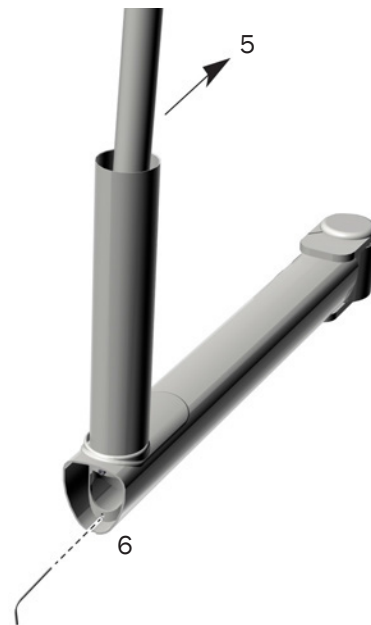
Abbildung 85. Installieren der Monitorbefestigung auf der Zusatzelementeseite
