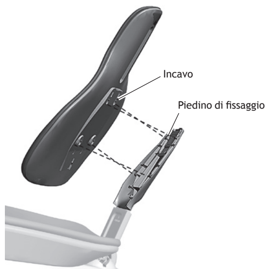
Figura 95. Installazione della tappezzeria dello schienale
