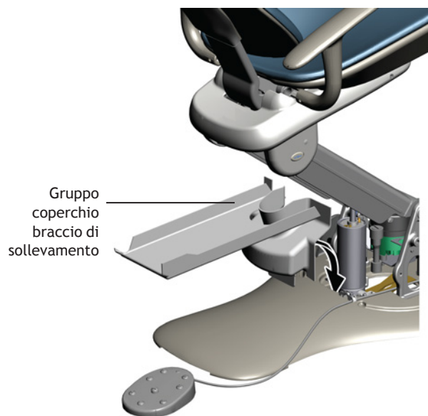
Figura 147. Installazione del gruppo del coperchio del braccio di sollevamento
